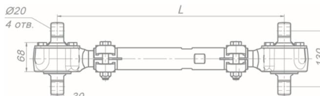
Допустимый диапазон регулировки ±14мм
